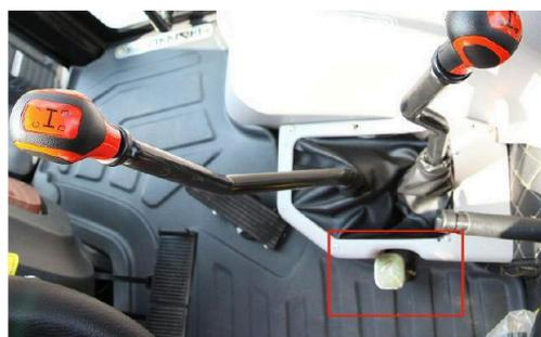
Рис. 2-27. Блокировка дифференциала
