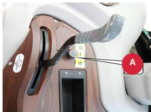
Рис. 2-22. Ручка управления подачей топлива
