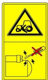
Рис. 1-16. Знак безопасности при запуске двигателя
