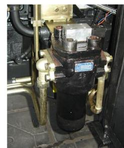
Рис. 4-11. Фильтр контура высокого давления гидравлической системы
