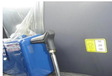
Рис. 2-72. Рычаг вала отбора мощности
