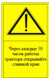
Значение: во избежание выхода из строя пневматической тормозной системы через каждые 50 часов работы трактора открывайте сливной кран для слива скопившегося конденсата в резервуаре для хранения воздуха.
