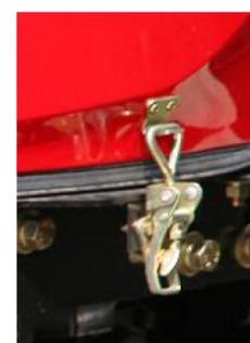
Рис. 2-41. Защелка капота
