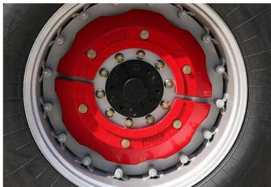
Рис. 2-37. Задний противовес
