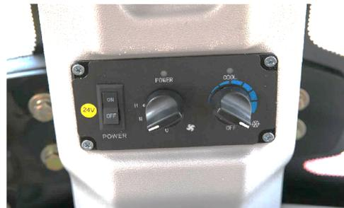
Рис. 2-44. Панель управления климатом кабины
