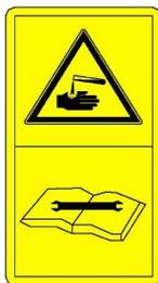
Рис. 1-19. Знак безопасности, относящийся к аккумуляторной батарее
